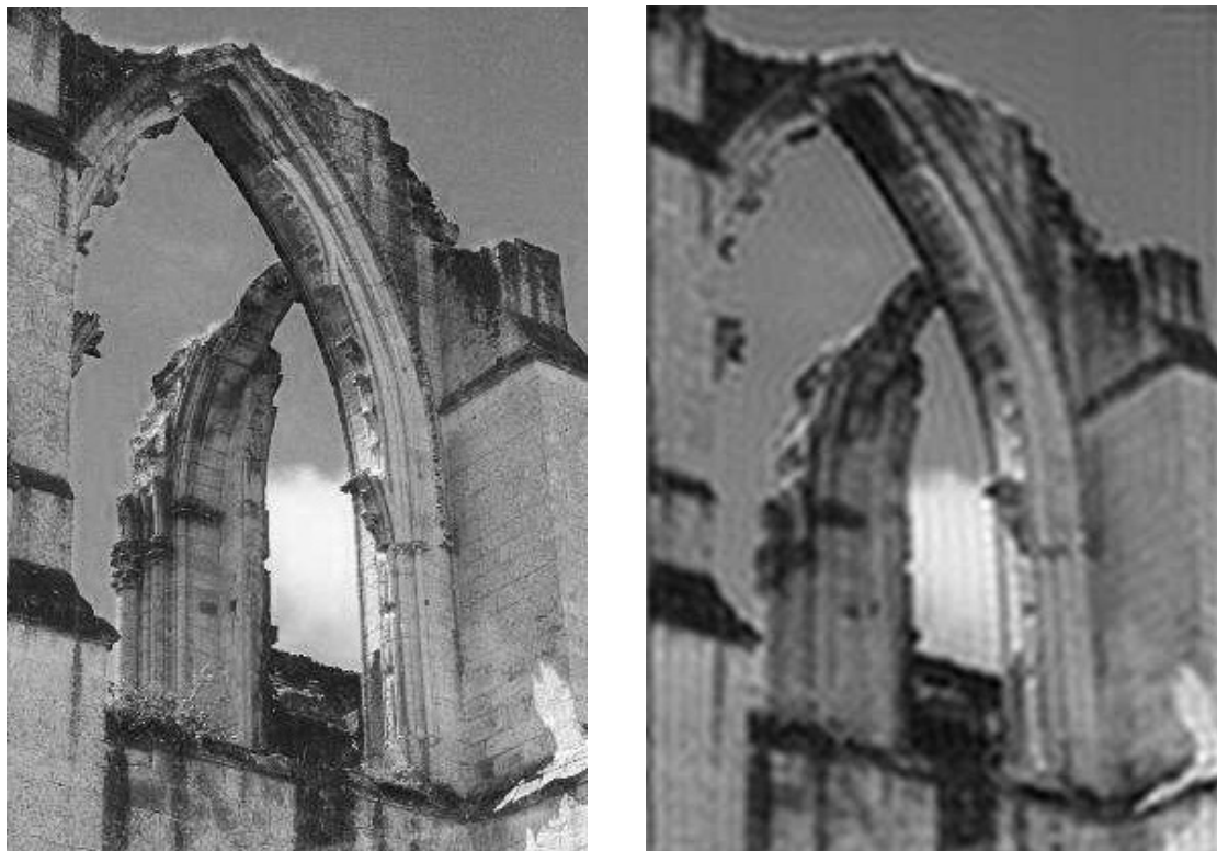
FIGURE 1 – Phénomène de Gibbs : quand on compresse trop l'image, la qualité s'en ressent...
